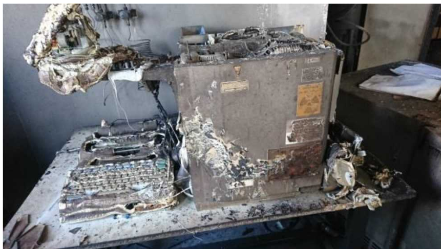
＜焼損したガスクロマトグラフの状況＞
